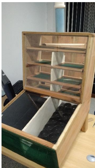
Figura 6 - Minisecador Solar com coletor dividido em tradicional e colmeia .
